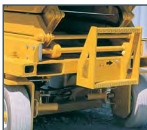
Échelle d'accès, ancrages de manutention et pochettes pour fourche de chariot élévateur
