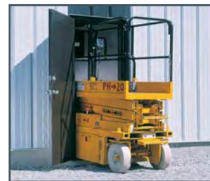
Circule facilement dans un cadre de porte de 32 po (PHE20)
